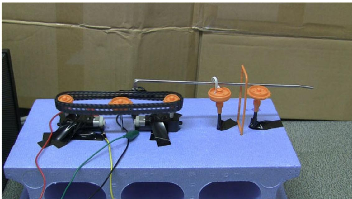
図2 無限軌道方式によるソフトアクチュエータのプロトタイプ
